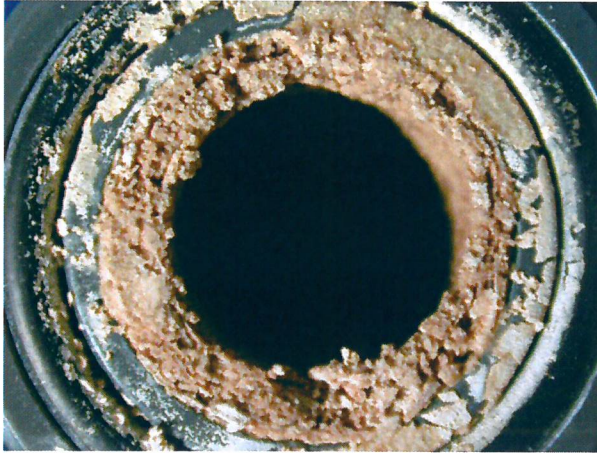
〈그림 1〉 소변 분리 회수 관거에서의 스케일 발생
