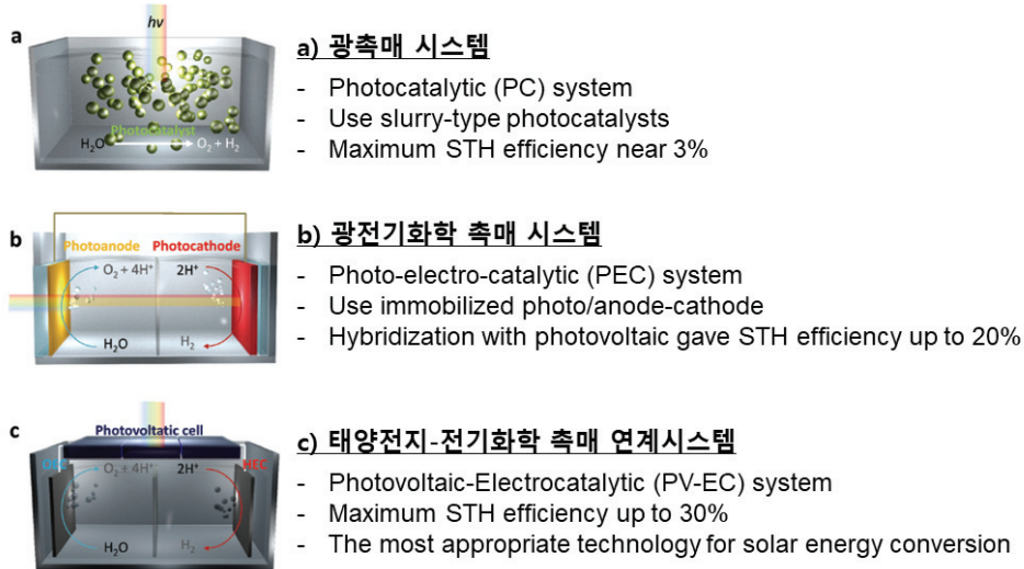
그림 1. 태양에너지를 활용한 물 분해 시스템의 Solar-to-Hydrogen(STH) 효율 비교 (a) PC, (b) PEC, (c) PV-EC 시스템 (Kim et al., 2019)
